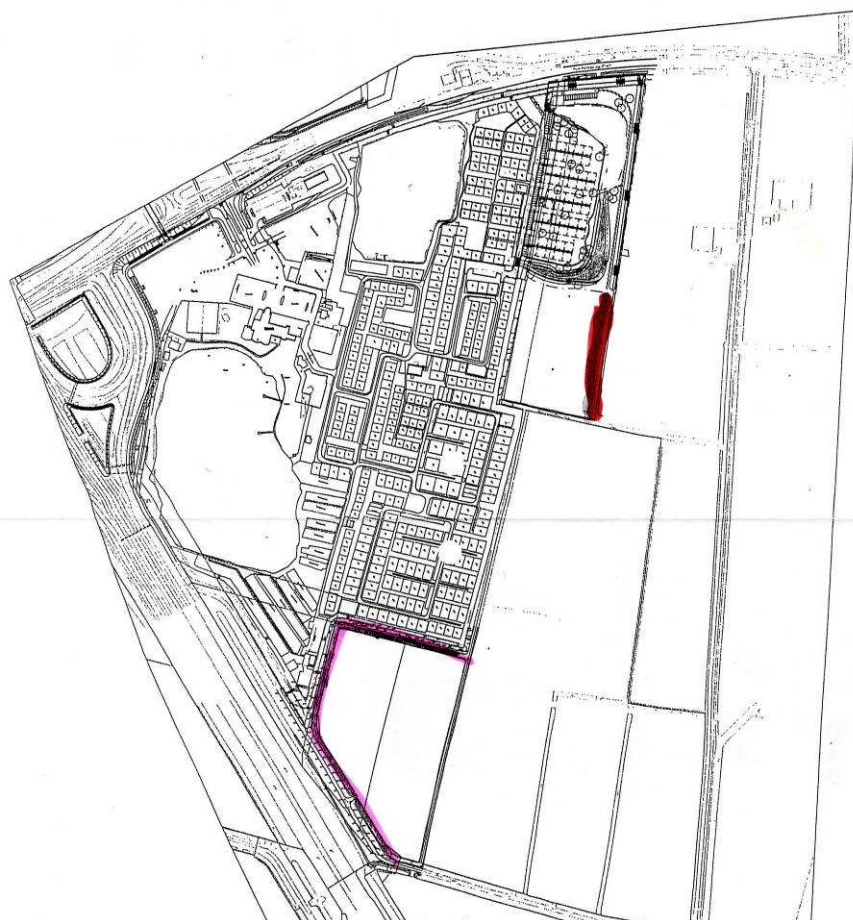
Overzicht van de gedempte watergang aan zuidzijde (roze) en de nieuw gegraven watergang aan de oostzijde (donker rood)
