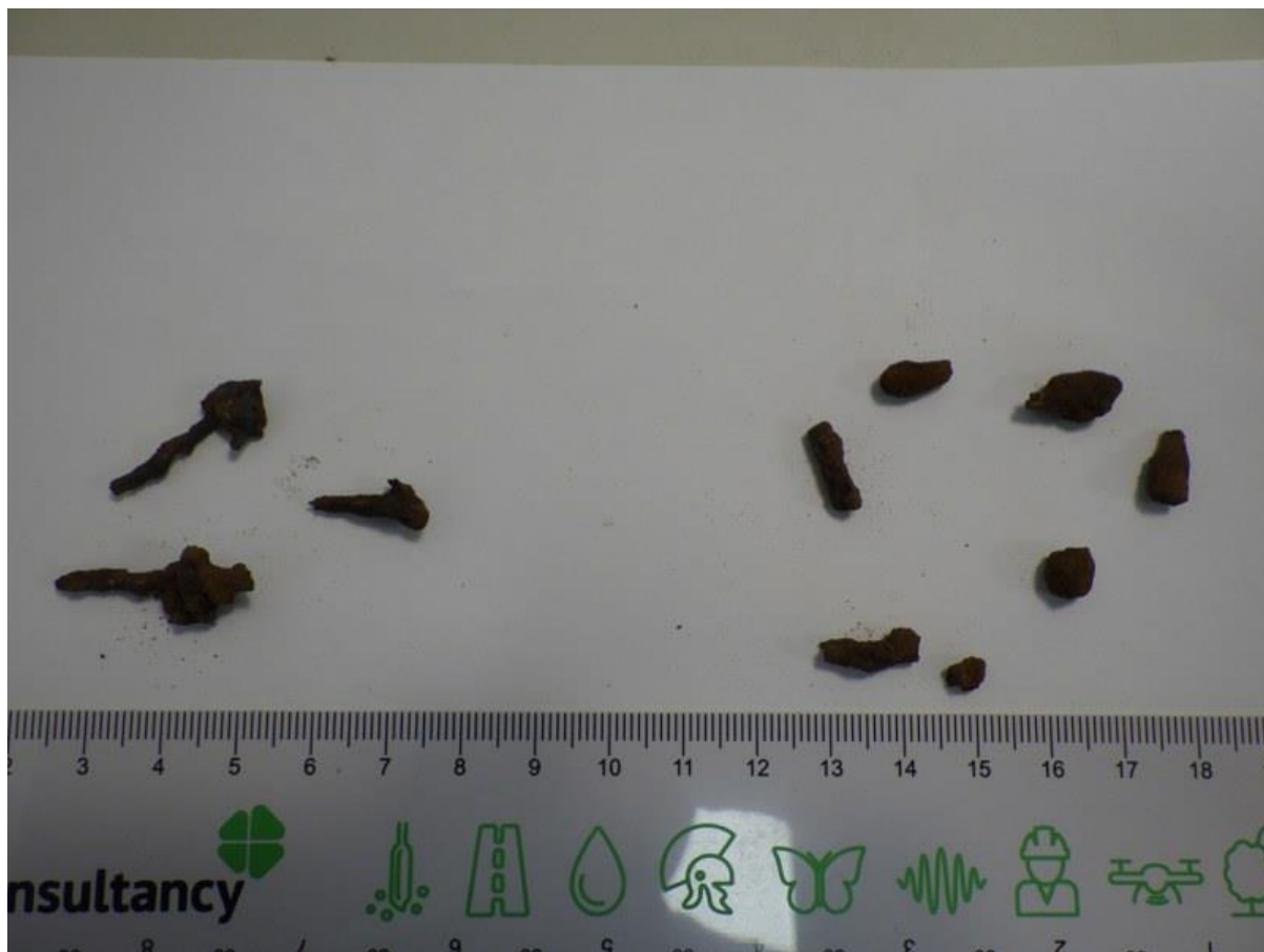
Figuur 2.3: Aangetroffen ijzeren fragmenten uit boring 1 -0-80
