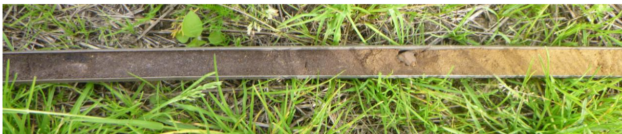
Figuur 22: De gutskern ter plaatse van boorpunt 17 met geheel links de humusrijke toplaag, links van het midden het pakket matig humeus zand met op de overgang naar de BC-horizont (rechts), een fragment aardewerk (rechts van het midden).
