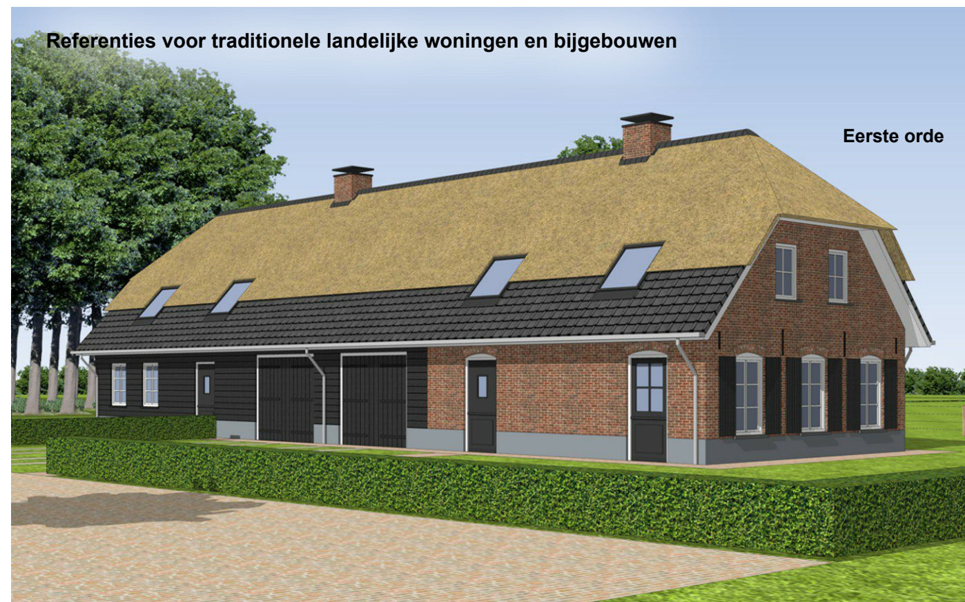
Gevel georiënteerd naar het hofje en kopgevel (metselwerk) met asymmetrische gevelindeling en rieten kap
