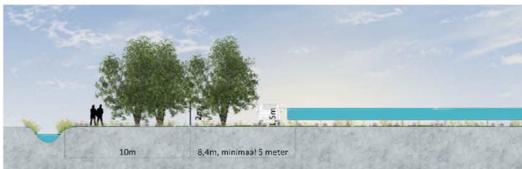
Afbeelding 19. Doorsnede (1) noord-zuid met ruimte langs watergang: wandelen, onderhoud en beplanting
