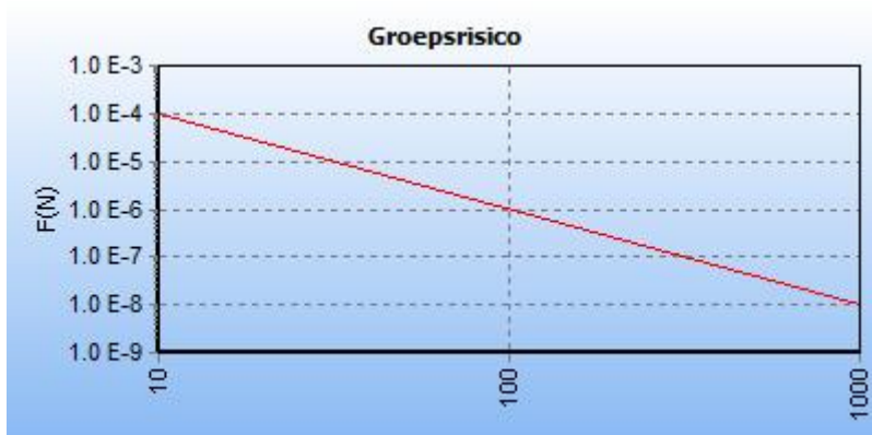
5.4 Figuur 5.4 FN curve voor 1674_leiding-N-570-45-deel-1 van N.V. Nederlandse Gasunie voor de kilometer tussen stationing 0.00 en stationing 730.00
