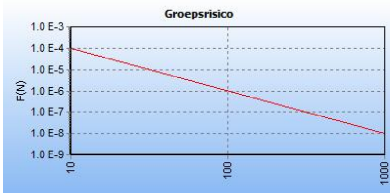
5.4 Figuur 5.4 FN curve voor 1674_leiding-N-570-45-deel-1 van N.V. Nederlandse Gasunie voor de kilometer tussen stationing 0.00 en stationing 730.00
