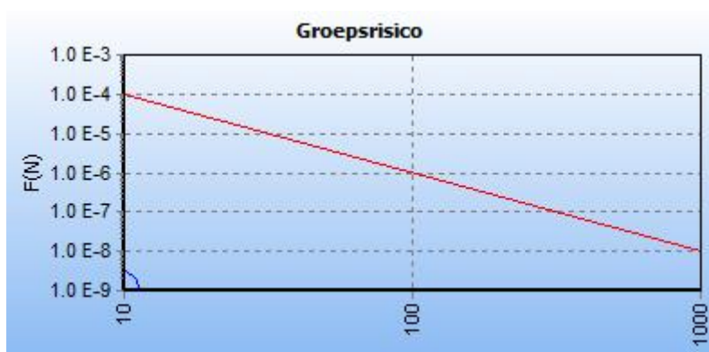
Afbeelding 10 fN-curve buisleiding N-570-20-deel-1, huidige situatie
