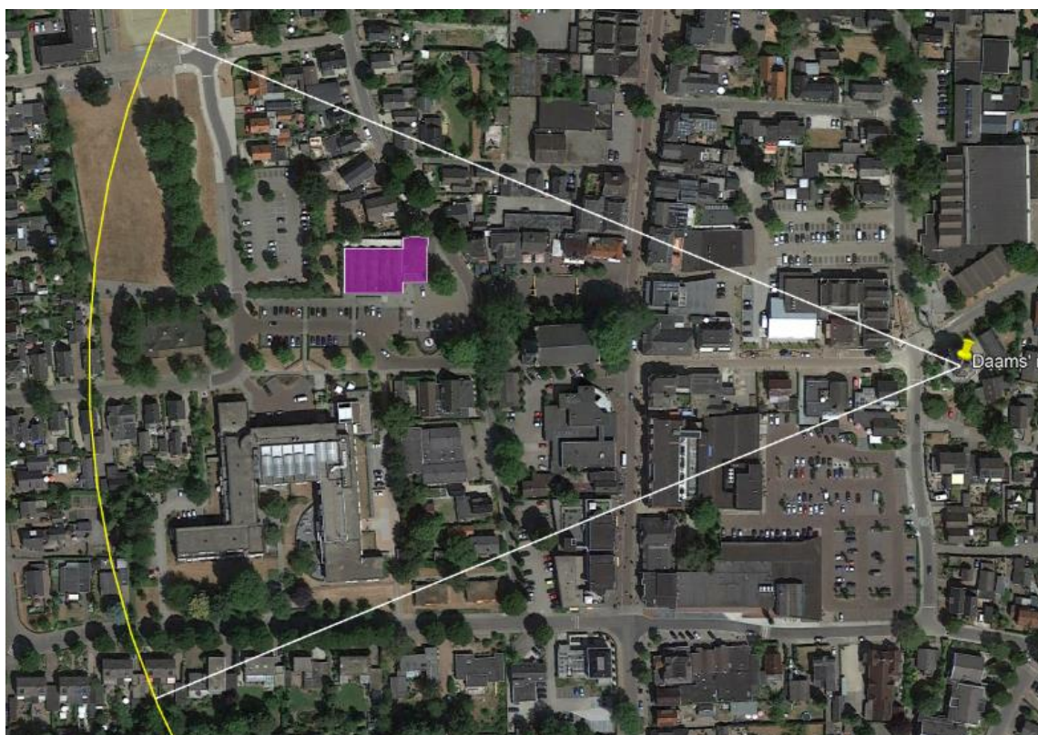
Afbeelding 1: Luchtfoto van het gebied ten westen van de Daams' Molen. De luchtfoto is zuiver noord georiënteerd. De gele cirkelboog geeft de straal van 400 meter rondom de molen aan. De witte lijnen zijn de graden 247,5 en 292,5 (270 is zuiver west) met de molen als middelpunt, het gebied tussen de witte lijnen is windhoek west. In paars het grondvlak van de Dekamarkt in de bestaande situatie. (Bron: Google Earth).
