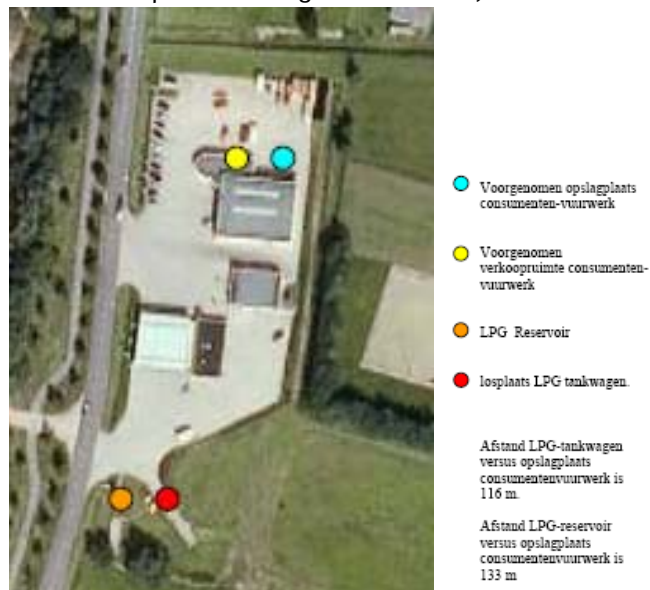
Figuur 3.1 Overzicht ligging opslag vuurwerk en LPG
