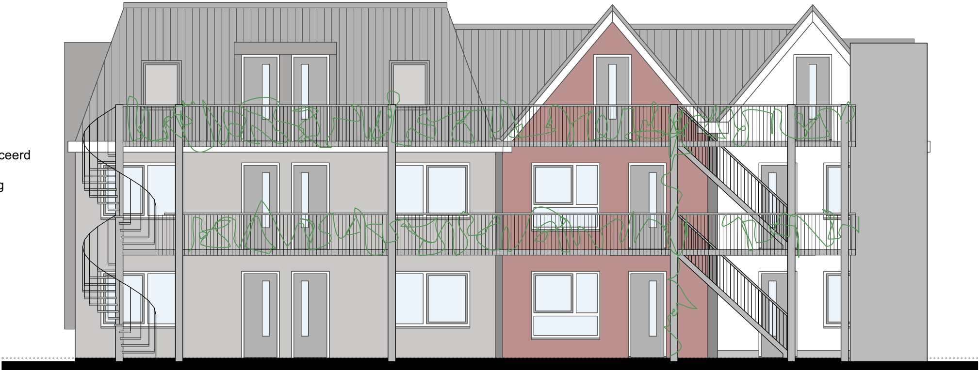
ZUIDGEVEL met galerij trappen en lift -nieuw-
