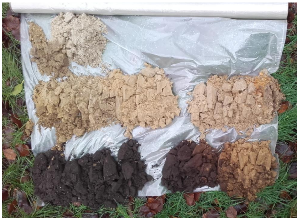
Afbeelding 4.1: Bodemopbouw boring 2 met esdek op BC-rest (foto: Greenhouse Advies).
