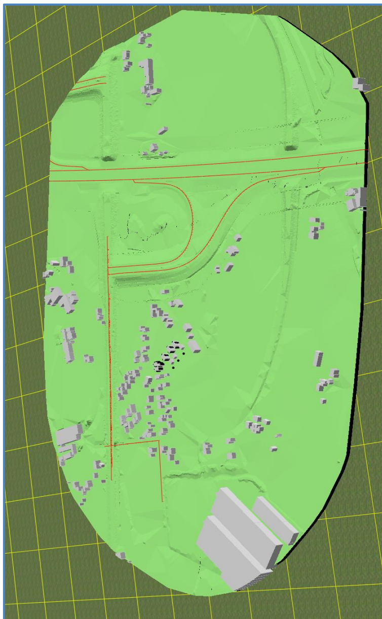
Afbeelding 5. Rekenmodel wegverkeerslawai, 3d-weergave
