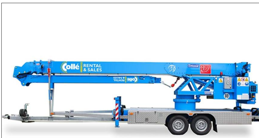
Voorbeeld van een lichte, mobiele kraan. Geschikt voor plaatsen van lichte lasten zoals kozijnen, dakplaten en gordingbalken.
