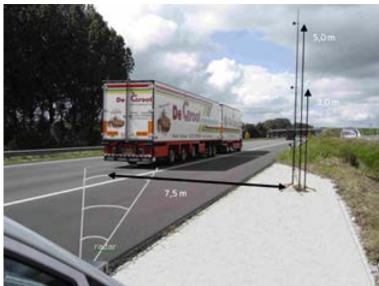
Meetopstelling volgens de SPB-methode
