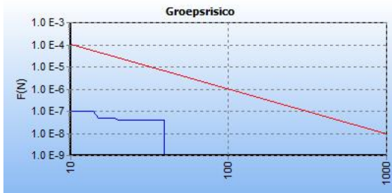
5.4 Figuur 5.4 FN curve voor leiding-N-556-75 voor de kilometer tussen stationing 950.00 en stationing 1950.00
