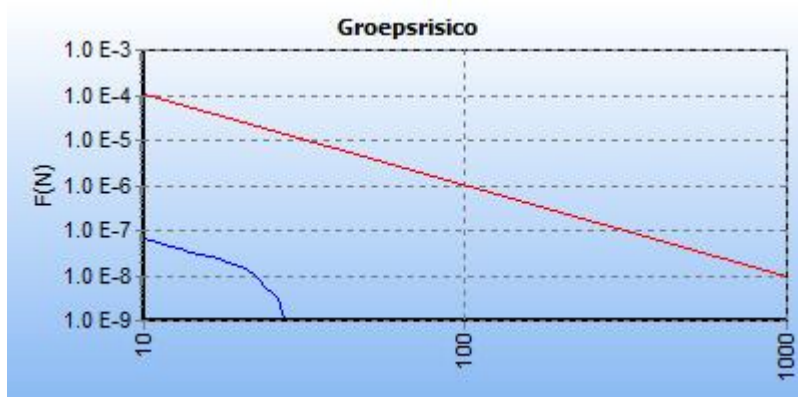
5.4 Figuur 5.4 FN curve voor leiding-N-556-75 voor de kilometer tussen stationing 950.00 en stationing 1950.00
