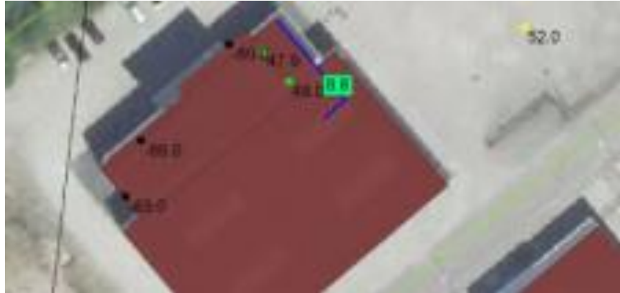
Figuur 13: Geluidbelasting op gevel Uiterwaardenstraat 19
