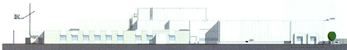
Figuur 8: Aanzicht Elburg Foods (voorgevel zuidwest) met daarop weergegeven een nieuwe stikstoftank.
