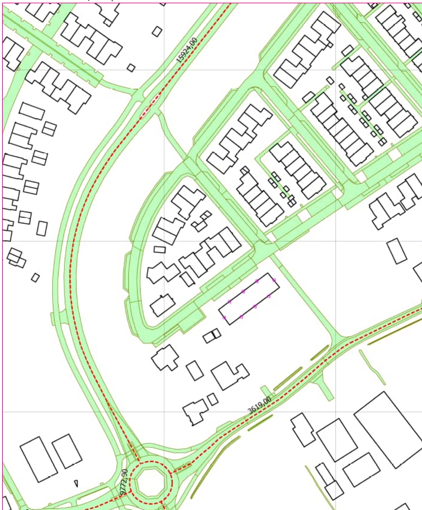
Figuur 4.1: overzicht van het akoestisch rekenmodel met de ligging van objecten, de harde bodemvlakken ( B_f = 0,0 ) en de toets-/rekenpunten
