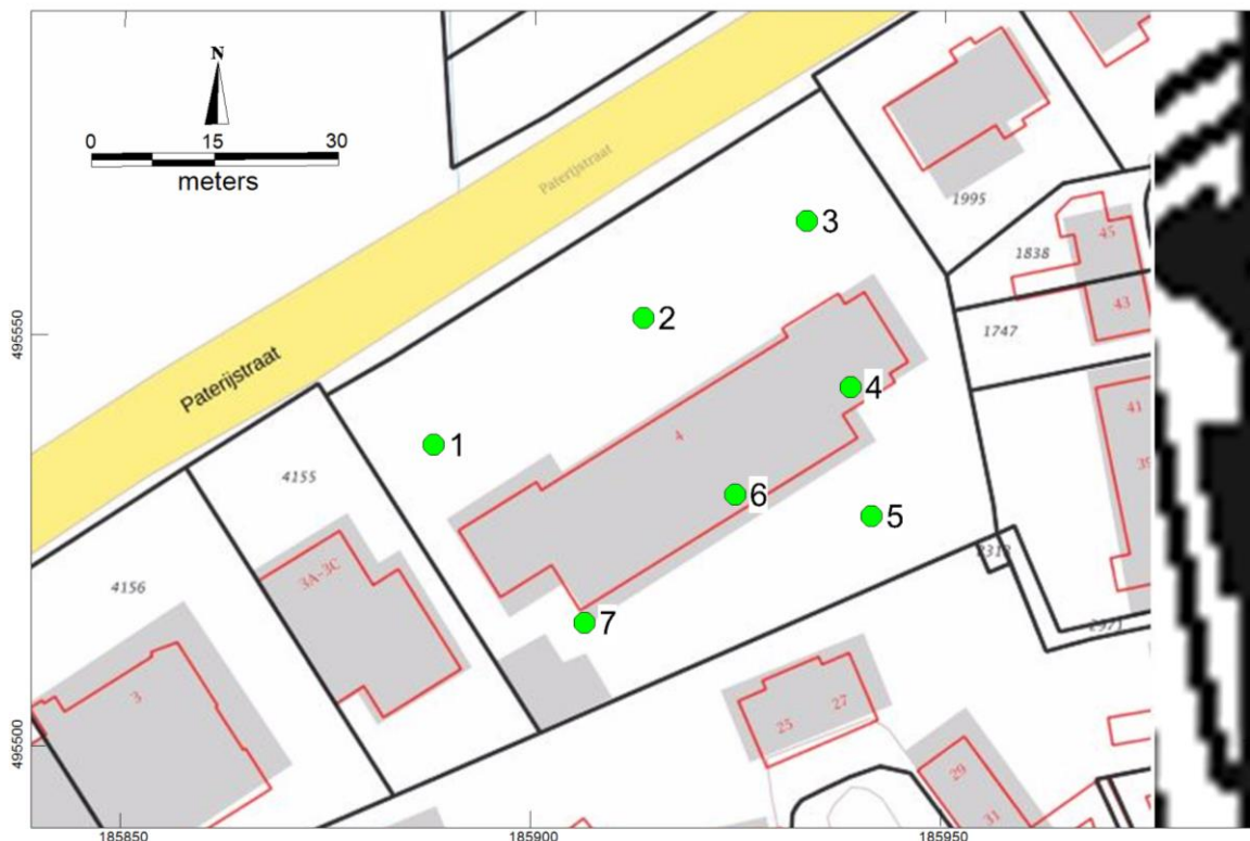
Figuur 4 Ligging van de boringen. De punten 4 en 6 zijn in de voormalige kruipruimte geplaatst.
