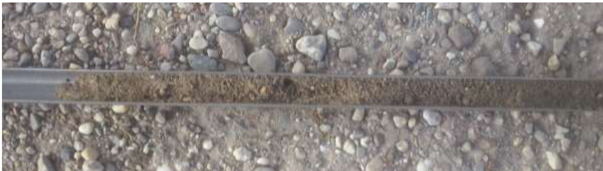
Figuur 4: Foto van boring 15 met rechts het humusrijke zand en links het matig humeuze zand.
