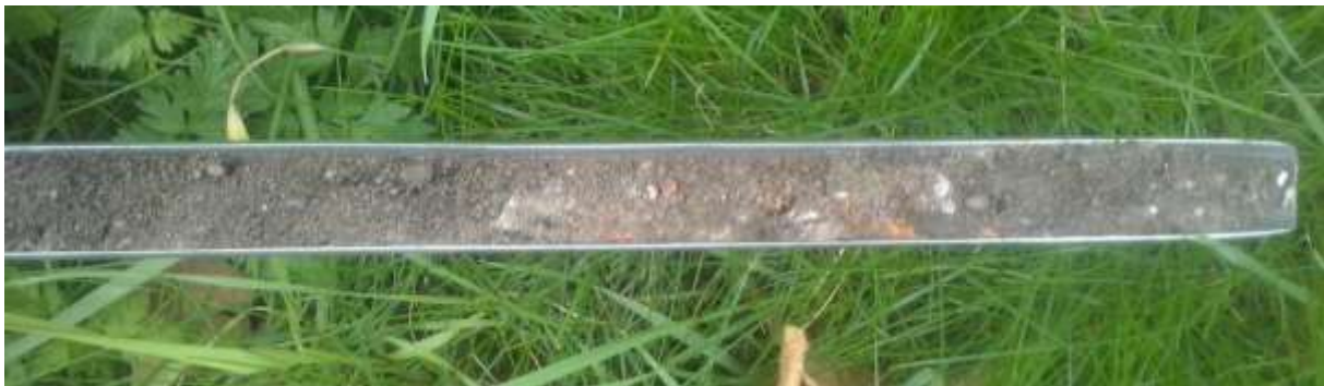
Figuur 3: Foto van boring 2 met de relatief puinrijke laag die daarin is aangetroffen op anderhalve meter beneden het maaiveld.
