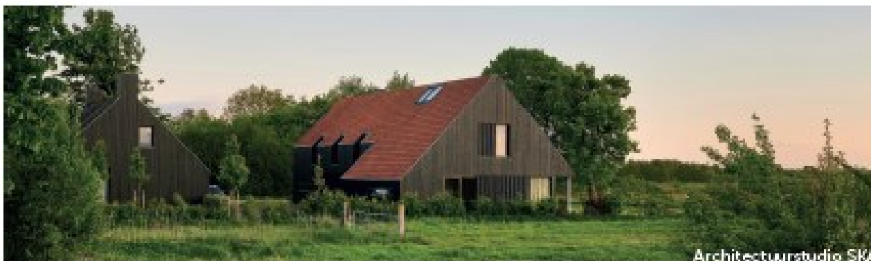
Materialen die passen bij het boeren erf (hout). Architectuur eigentijds en ingetogen. Geïntegreerde dakgoten. Kopgevel dieper en breder dan de rest van het volume
