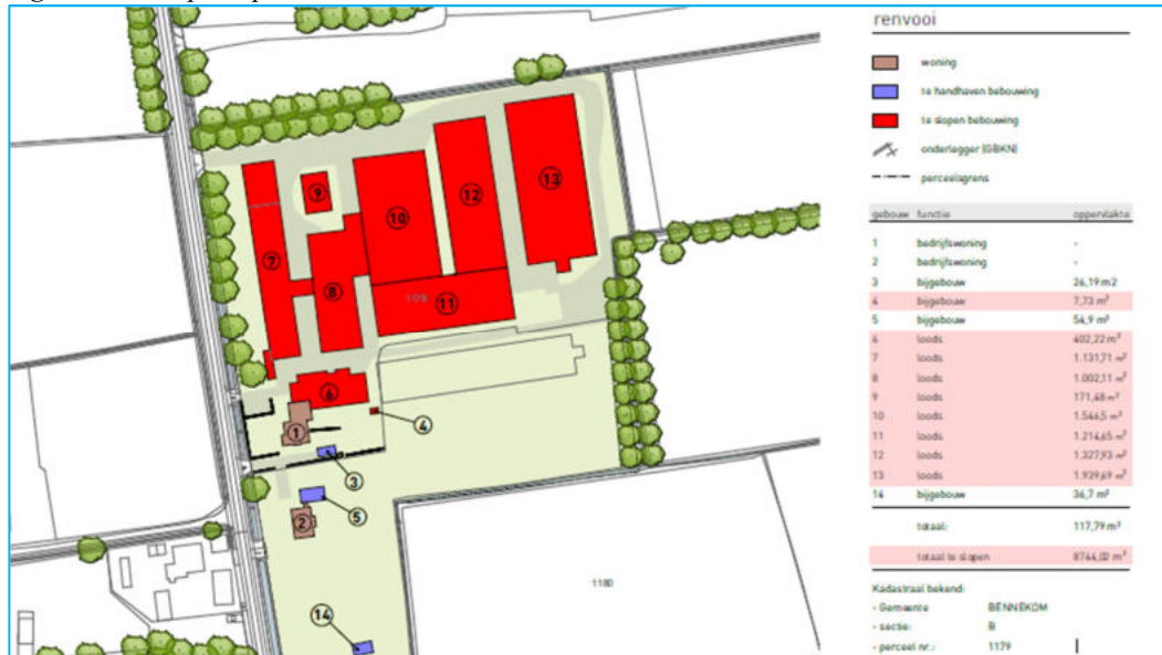
Figuur 3: te slopen opstallen
