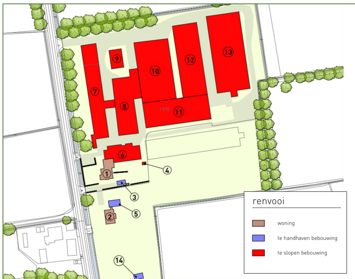
Figuur 1.1: Overzicht sloop.
