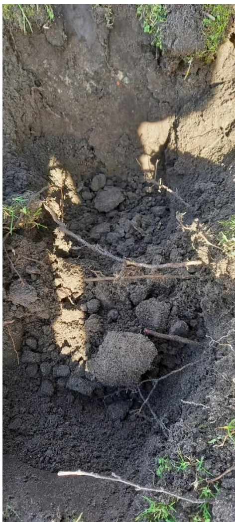
Figuur 13 en 14: Boom 3. Intensieve beworteling dicht onder maaiveld op rand kroonprojectie. Boom 1 steunwortel op 30 cm diep en 7 m uit stam. Bij geplande werkzaamheden verliest de berk meer dan de helft van het wortelstelsel en zal de situatie onhoudbaar zijn, zowel qua stabiliteit, als qua vocht en voedselvoorziening.
