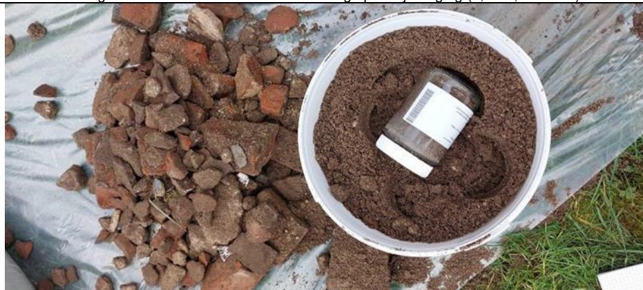
Foto 16: Boring/ proefgat 012 - Deellocatie 2 – Puin met zand (traject 0,35–0,50 m-mv)
