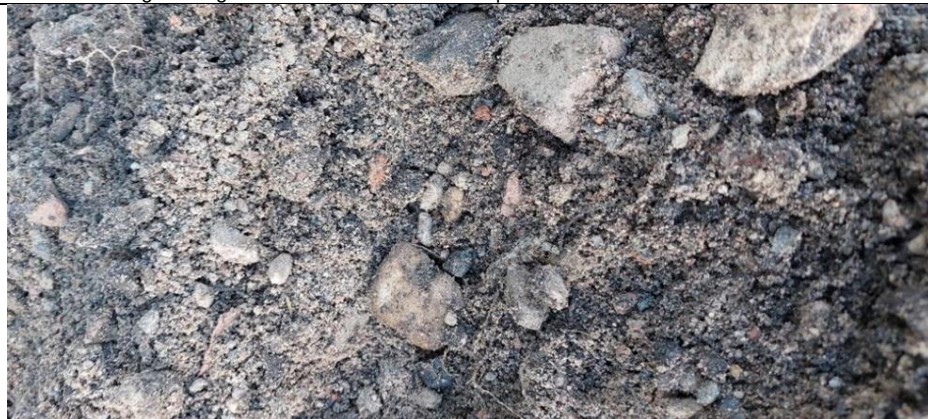
Foto 19: Boring 013 - Deellocatie 2 – Mengpuin (0,08-0,20 m-mv)
