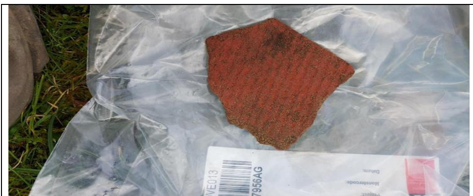
Foto 17: Boring 012 - Deellocatie 2 – Asbestverdacht plaatmateriaal (traject 0,35–0,50 m-mv)
