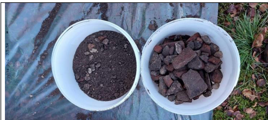
Foto 21: Boring/ Proefgat 013 - Deellocatie 2 – Puin met zand (0,35-0,50 m-mv)
