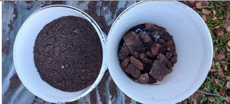
Foto 20: Boring 013 - Deellocatie 2 – Zand met matige puin bijmenging (0,20-0,35 m-mv)
