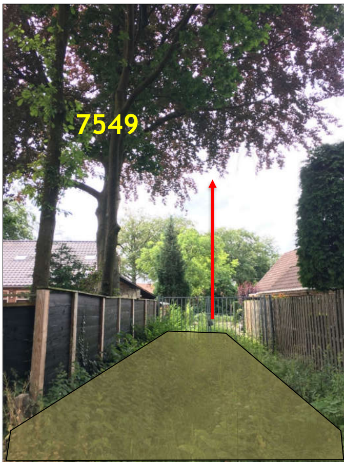
Afbeelding 23: De takvrije ruimte boven de nieuwe toegangsweg vanaf de Noordelijke Spoorstraat (blauw) is ruim voldoende voor bouwverkeer (>5 meter)
