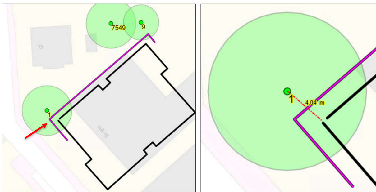
Afbeelding 17: Gevel nieuwbouw (zwart) en werkruimte bouwsteigers (paars) binnen kroonprojectie boom 1
