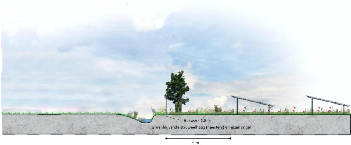
Afbeelding 2.10: Maatvoering van randen in relatie tot hoogte paneeltafels aan de noordzijde
