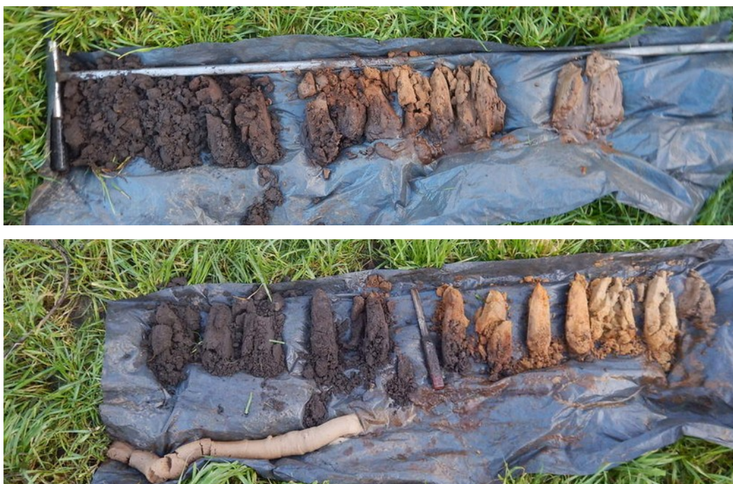
Figuur 12: Boorprofielen 1 (boven) en 3 (onder). Het opgeboorde materiaal is uitgelegd van linksboven naar rechtsonder.
