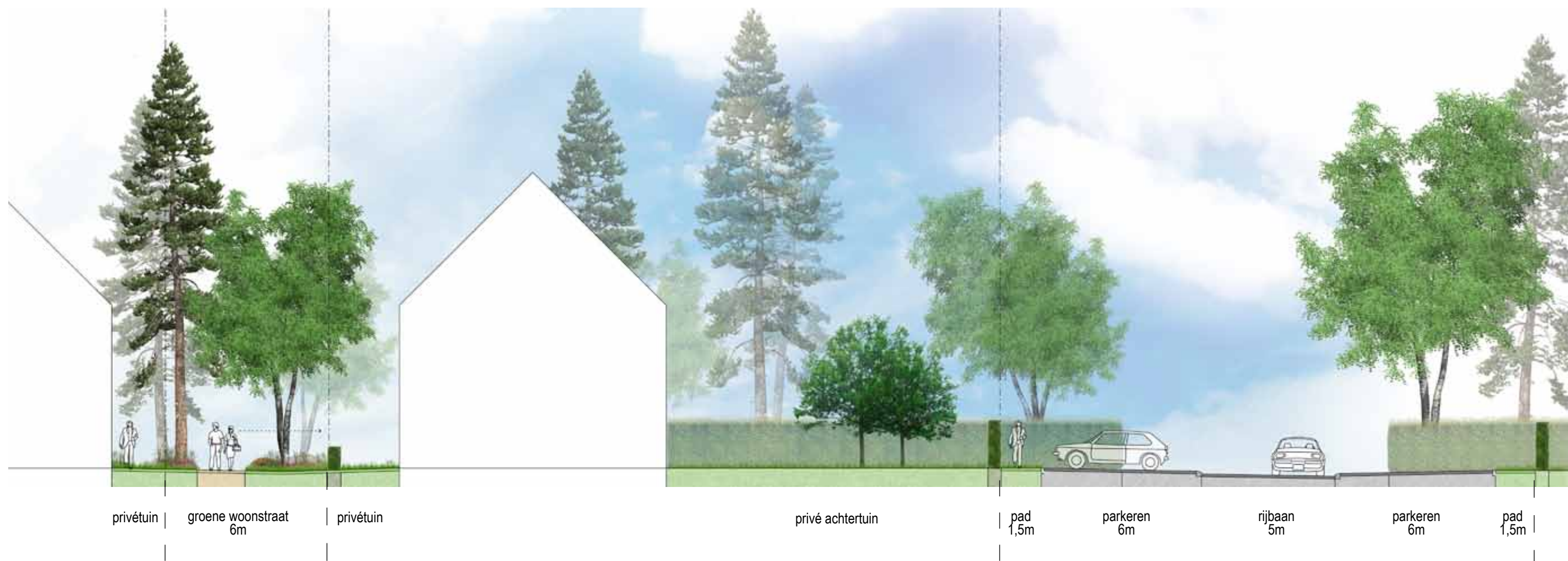
Doorsnede over één van de groene woonpaden en één van de oost westelijke inpridders die toegang geven tot het parkeercluster in het Heidewoonlandschap
