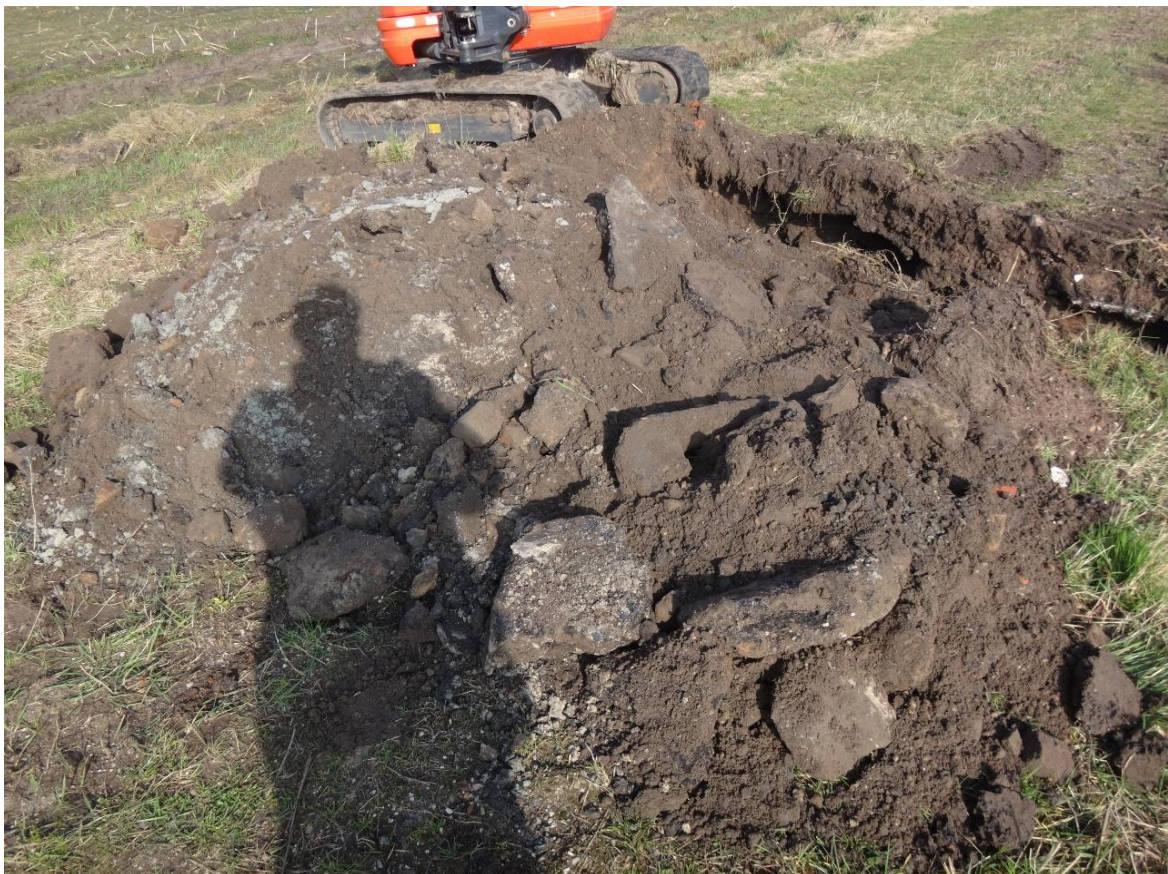
Sleuf SL05 (detail bodemvreemd materiaal)
