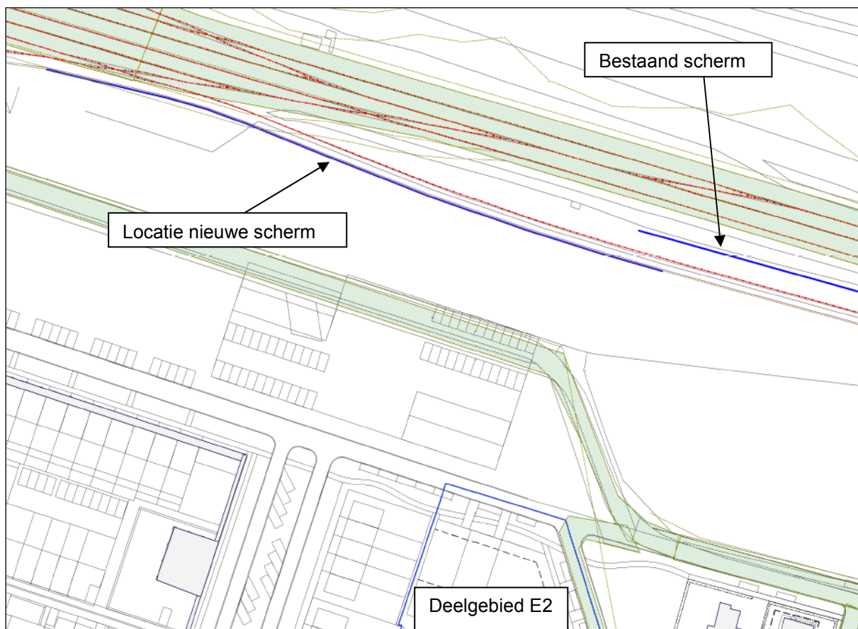
Figuur 3: Weergave ligging nieuw tijdelijk scherm: hoogte 2 m B.S., lengte 185 m
