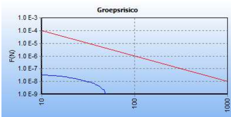
5.2 Figuur 5.2 FN curve voor 8736_leiding-N-568-16-deel-1 van N.V. Nederlandse Gasunie voor de kilometer tussen stationing 0.00 en stationing 0.00
