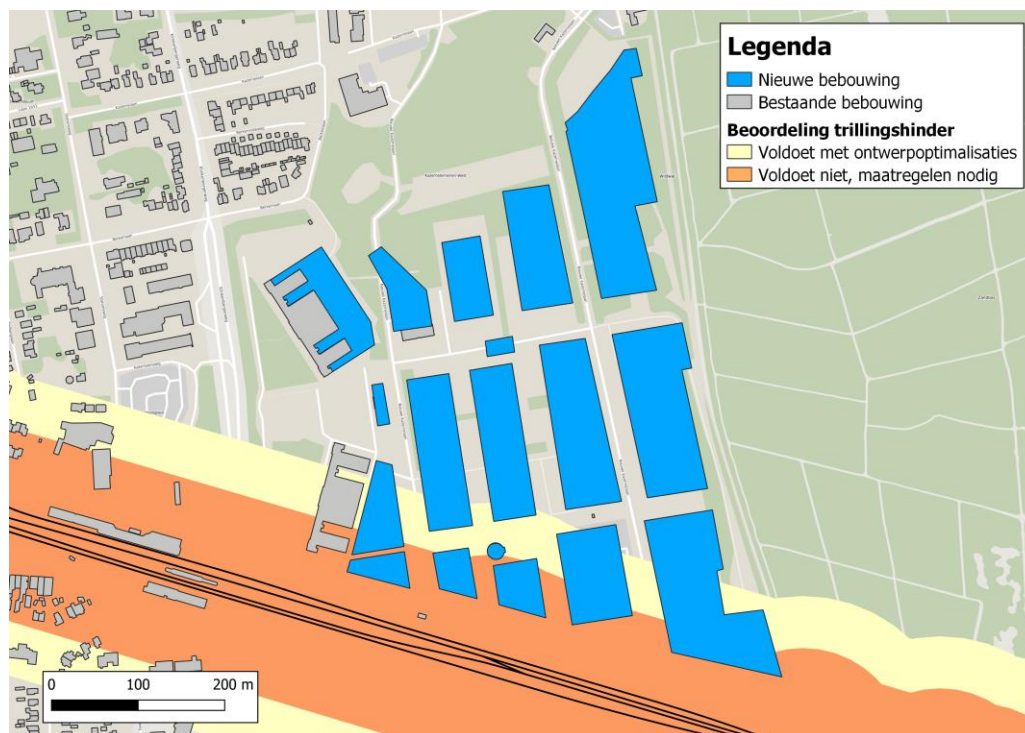
Figuur 5-4 Contouren trillingshinder ‘Kritische werkruimte’
