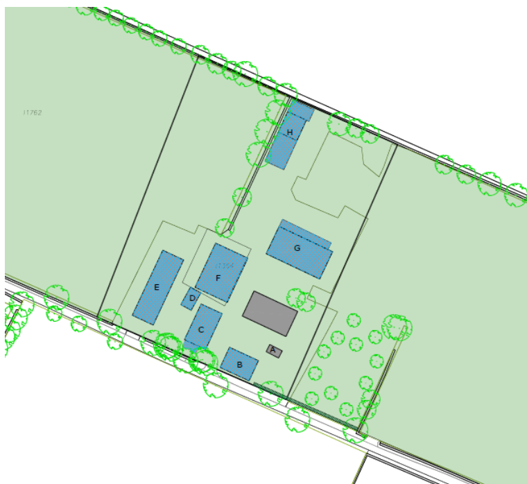
Afb. 4 Bestaande situatie. De aangegeven gebouwen in het blauw worden gesloopt.
