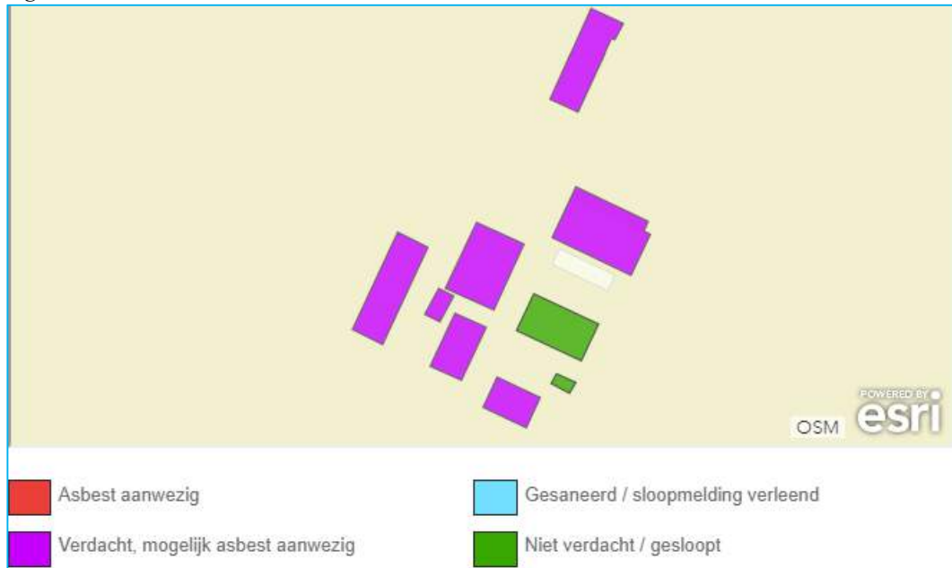
Figuur 7: asbestdakenkaart Provincie Gelderland
