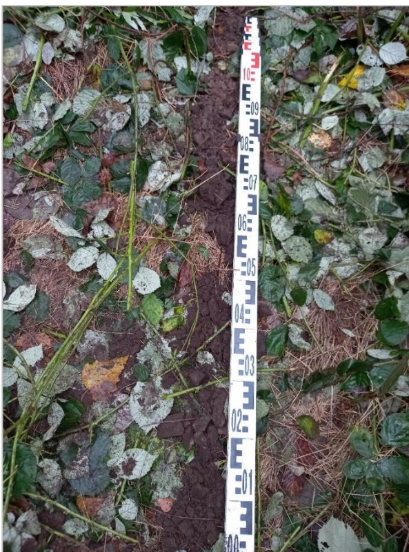
Figuur 7: bodemprofiel tot circa 130 centimeter beneden maaiveld. Vanaf circa 90 cm -mv. neemt het organisch stofgehalte zichtbaar af.
