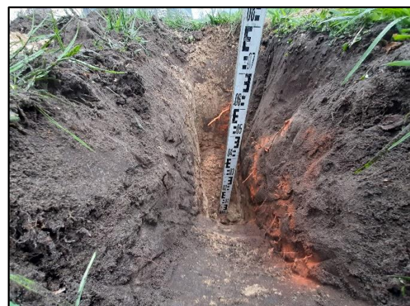
Figuur 16. Proefsleuf 3: matig extensieve beworteling op de rand van de kroonprojectie.
