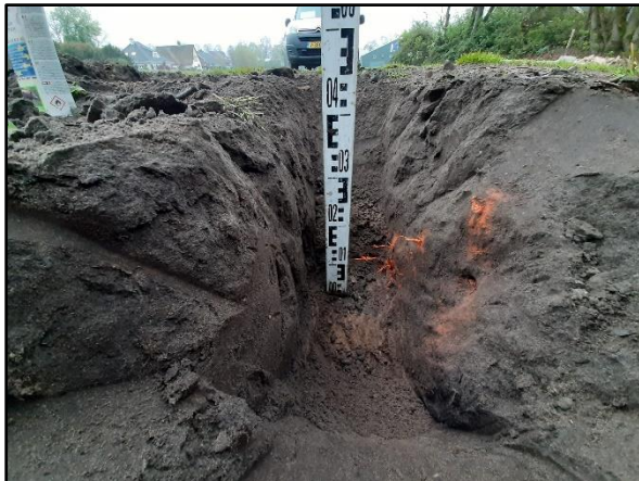
Figuur 14. Proefsleuf 1: extensieve beworteling op de rand van de kroonprojectie.
