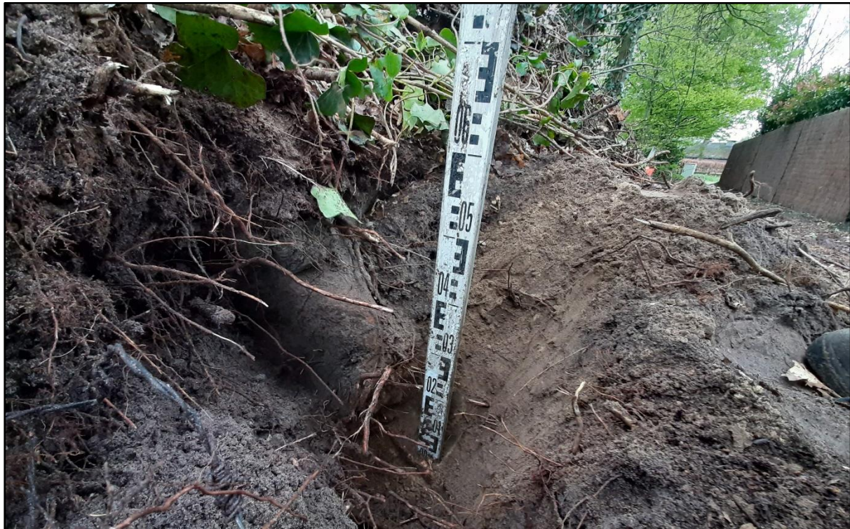
Figuur 12. Aangetroffen beworteling proefsleuf boom 58.
