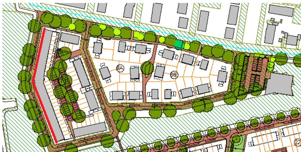
Figuur 5: dove gevels (in rood) vanwege A30 tweede verdieping jaarring 2023
