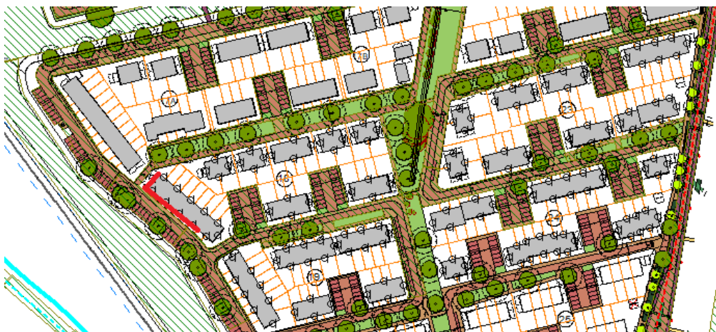
Figuur 7: dove gevels (in rood) vanwege A30 tweede verdieping jaarring 2023
