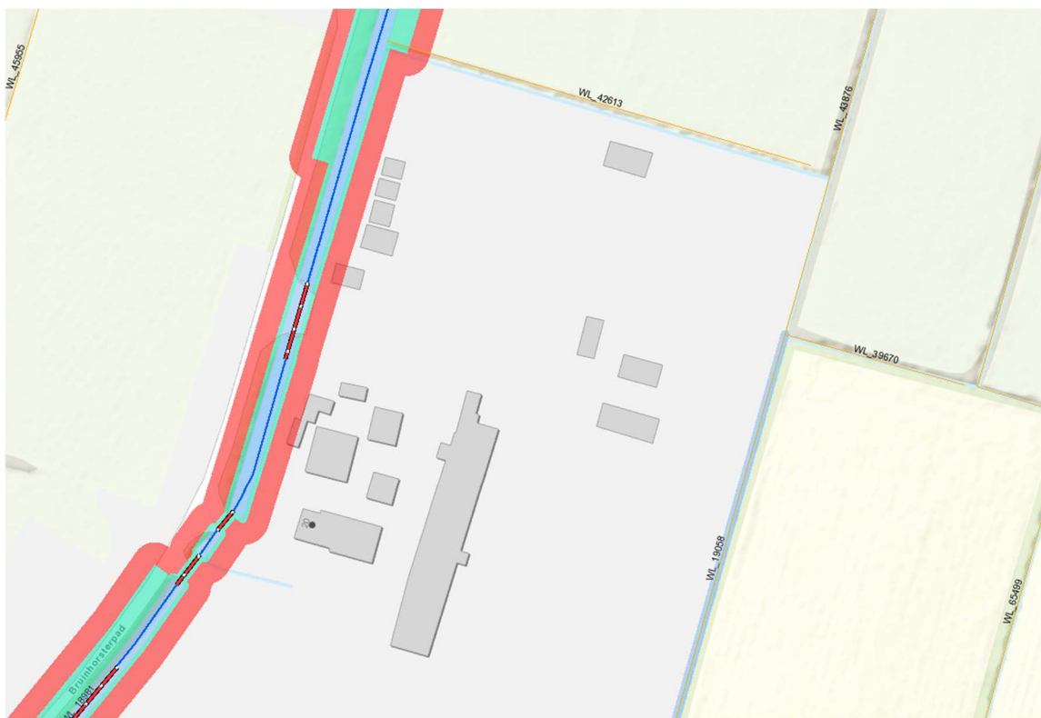
Figuur A-watgang (blauw, met beschermingszone rood) en C-watgangen (oranje) op de legger van Waterschap Vallei en Veluwe (bron: Waterschap Vallei en Veluwe)
