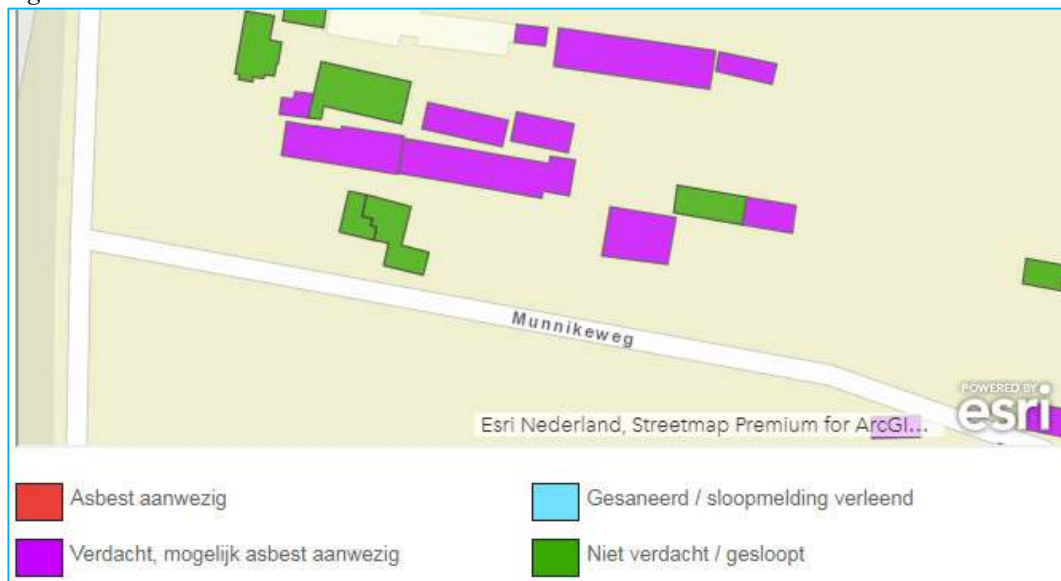
Figuur 3: asbestdakenkaart Provincie Gelderland
