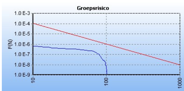
Figuur 9: FN curve van de kilometer met de hoogste overschrijdingsfactor (0.09) van de N-568-10. De ligging van de kilometer met de hoogste overschrijdingsfactor is hiernaast in het groen weergegeven op een topografische kaart.
