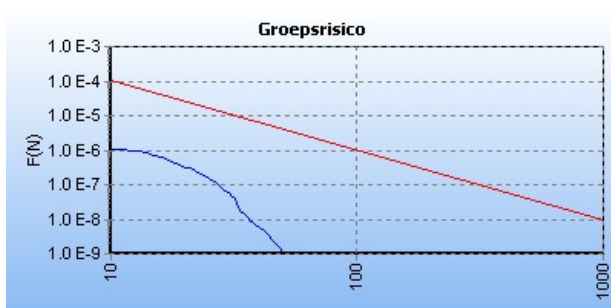
Figuur 13: FN curve van de kilometer met de hoogste overschrijdingsfactor (0.02) van de N-568-10. De ligging van de kilometer met de hoogste overschrijdingsfactor is hiernaast in het groen weergegeven op een topografische kaart.
