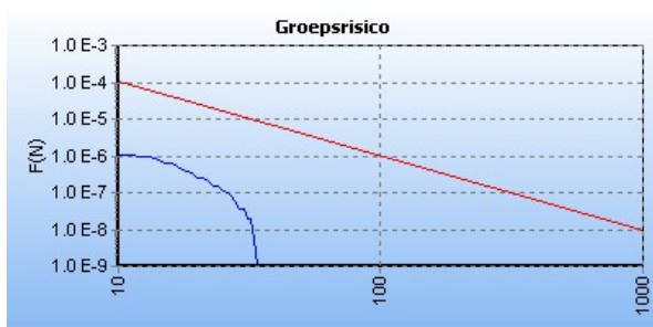
Figuur 11: FN curve van de kilometer met de hoogste overschrijdingsfactor (0.02) van de N-568-10. De ligging van de kilometer met de hoogste overschrijdingsfactor is hiernaast in het groen weergegeven op een topografische kaart.
