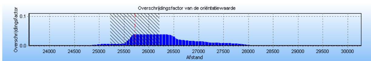
Figuur 6 Overschrijding van het groepsrisico als functie van de stationing van de N-568-10.
