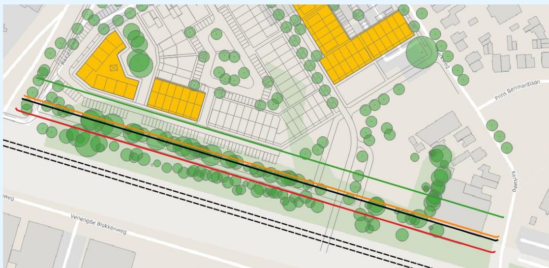
figuur 12: trillingsniveaus in de woning bij zware constructie. V_{eff,max} Groen 100 dB (A1), Oranje 106 dB (A2 nacht), Rood 112 dB (A2 dag, avond) - V_{per} Zwart 94 dB (A3).
