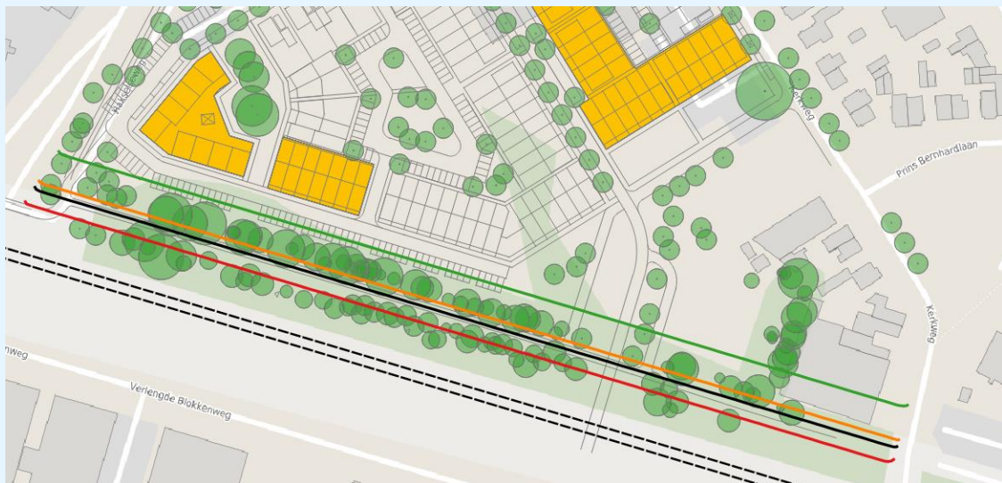
figuur 10: trillingsniveaus in de bodem. V_{eff,max} Groen 100 dB ( A_1 ), Oranje 106 dB ( A_2 nacht), Rood 112 dB ( A_2 dag, avond) - V_{per} Zwart 94 dB ( A_3 ).
