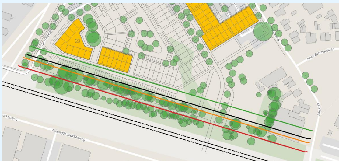
figuur 15: trillingsniveaus in de woning bij zware constructie. V_{eff,max} Groen 100 dB (A1), Oranje 106 dB (A2 nacht), Rood 112 dB (A2 dag, avond) - V_{per} Zwart 94 dB (A3).
