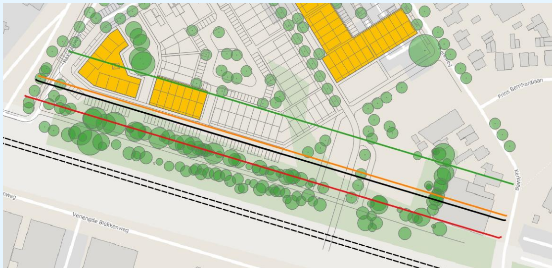
figuur 11: trillingsniveaus in de woning bij lichte constructie. V_{eff,max} Groen 100 dB (A1), Oranje 106 dB (A2 nacht), Rood 112 dB (A2 dag, avond) - V_{per} Zwart 94 dB (A3).
