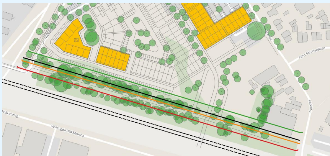
figuur 13: trillingsniveaus in de bodem. V_{eff,max} Groen 100 dB (A1), Oranje 106 dB (A2 nacht), Rood 112 dB (A2 dag, avond) - V_{per} Zwart 94 dB (A3).
