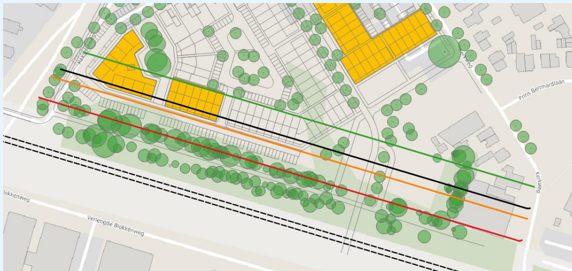
figuur 14: trillingsniveaus in de woning bij lichte constructie. V_{eff,max} Groen 100 dB (A1), Oranje 106 dB (A2 nacht), Rood 112 dB (A2 dag, avond) - V_{per} Zwart 94 dB (A3).
