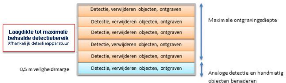
Figuur 46: Schematische weergave werkmethode laagsgewijze oppervlakedetectie
