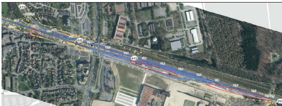
Figuur 4.7 Overzicht asbestverdachte deellocaties (rode contouren)
