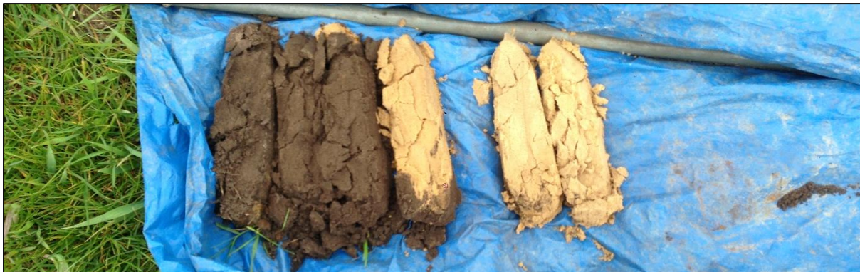
Boring 1: 0-70 cm -Mv. Representatief voor het verstoorde, zuidelijk deel van de enggronden, boorpunt 1, 5 en 10.
