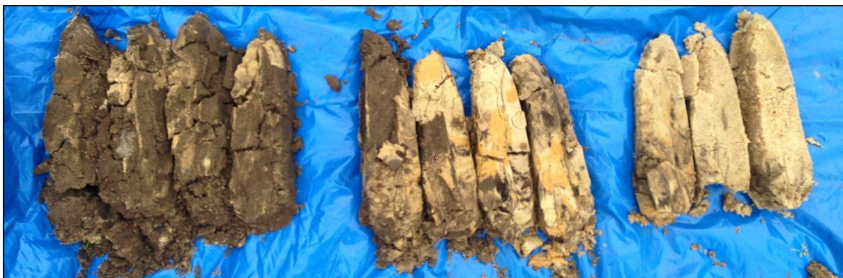
Boring 14: 0-130 cm -Mv. Deze boring is representatief voor het noordelijk deel van het plangebied.
