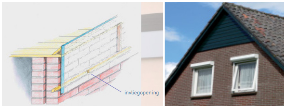
Figuur 12. Voorbeelden van geschikte gevelbetimmering (bron: Korsten & Limpens, Folder vleermuisvriendelijk bouwen).
