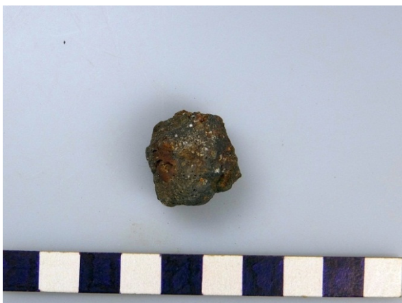
Afbeelding 3.15: niet-metaalslak V144. Het fragment is deels wat roestig, wat op silicaatrijke smeedslag zou kunnen duiden. De schaalverdeling is in cm.
