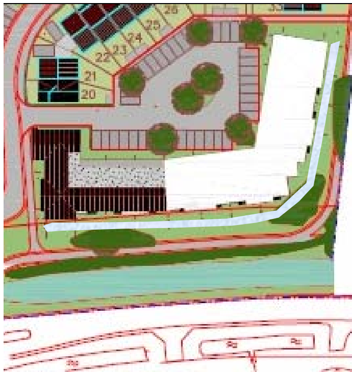
Figuur 4.4 Situatie van wadi in deelgebied C langs de zuid- en oostgevel van het appartementencomplex
