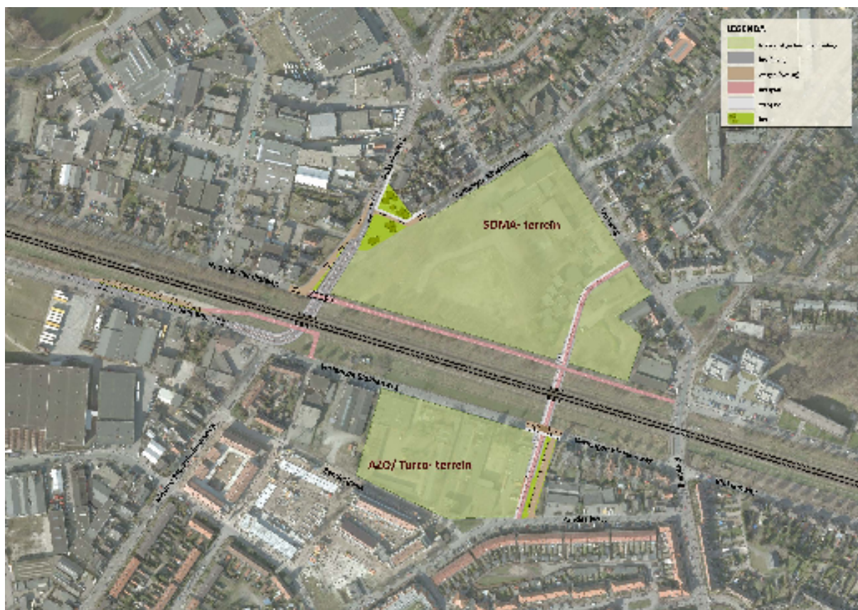
Figuur 2: Ontwerp nieuwe situatie met ongelijkvloerse spoorwegovergangen
